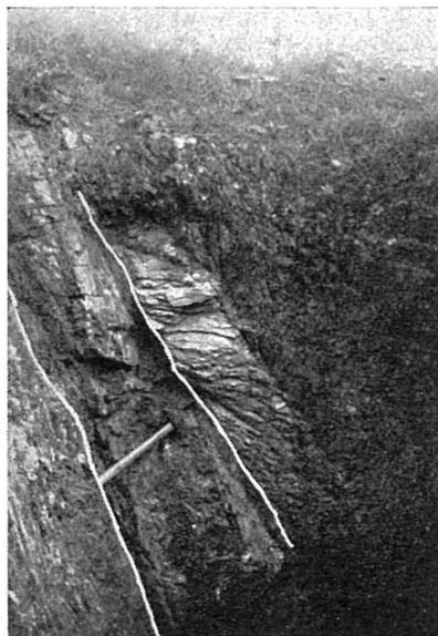
Fig. 1 — Pesquisa sobre o filão do Bouchal do Paulo. O filão é ladeado por salbandas argilo-brechóides e, do lado do tecto, a meio metro, observa-se uma pequena falha paralela; o xisto argiloso mosqueado encaixante mostra-se triturado.
