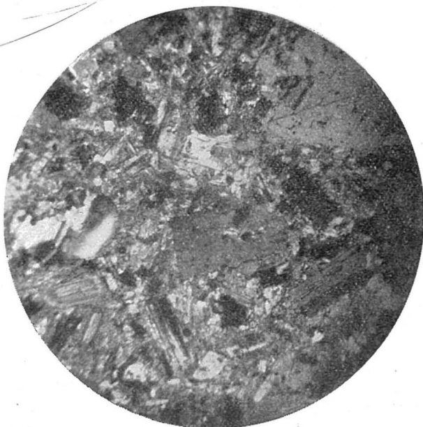
Fig. 2 — Granito de Argemela. O feldspato encontra-se profundamente alterado em minerais com tintas de polarização altas (L. P. — X. 16).
