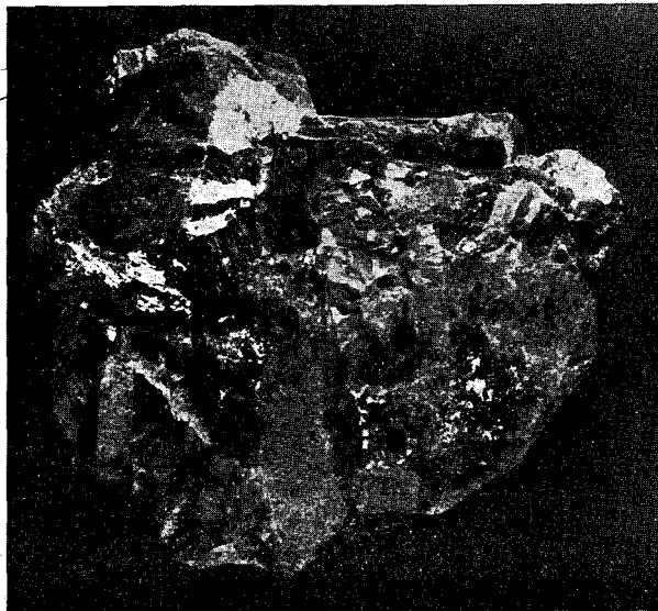
Fig. 2 — Tipo brechóide do minério do jazigo de Ceife; cinzento claro — xisto argiloso, cinzento escuro e branco — galena.
